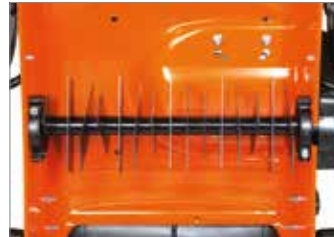
Rotor composto por 15 lâminas fixas.
