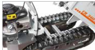
Chassis robusto com estrutura em aço. O baixo centro de gravidade fornece uma óptima estabilidade durante o trabalho, mesmo em terrenos inclinados. A posição alta do motor e da transmissão torna a manutenção muito cómoda.
