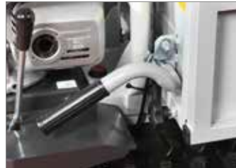
Basculamento manual com sistema de bloqueio automático.
