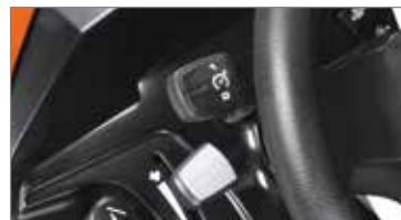
A função Cruise Control permite definir uma velocidade de avanço constante, otimizando assim o tempo de trabalho.
