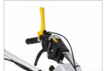
Alavanca de seleção das mudanças no guiador de engate fácil.
