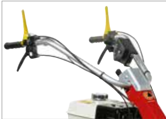
Embraiagens de direção independentes nas rodas motrizes com bloqueio das rodas que permitem manobrar a máquina com extrema facilidade.
