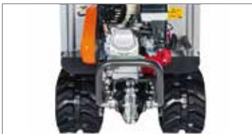
Protecção traseira em metal para garantir a segurança do utilizador.
