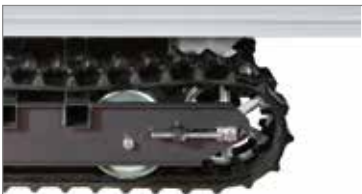
Carro robusto com roda de guia, perfeitamente equilibrado para garantir a distribuição correcta das cargas e uma boa aderência em qualquer terreno.
