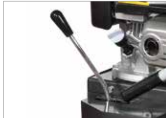
Comando seletor das velocidades com alavanca.
