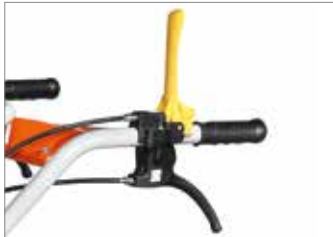
Alavanca no guiador para engate das mudanças.
