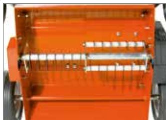
Rotor com 28 lâminas flutuantes montadas em rolamentos de esfera e sistema de lubrificador.
