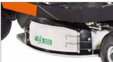
"4-cutting device": sistema de corte versátil que inclui mulching, recolha, descarga lateral standard e defletor para descarga traseira.
