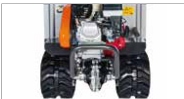
Hátó fém védőburkolat a gépkezelő biztonsága érdekében.
