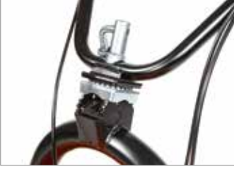
İlgili gidon kolu aracılığıyla dikey ve yatay olarak ayarlanabilen gidon.
