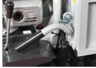
Otomatik kilitleme sistemli manuel eğme.
