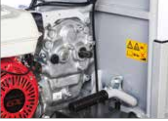
2.100 dev/dak hızında bağımsız güç çıkış ünitesi mevcuttur.
