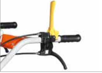
Vites değiştirmek için gidon üzerinde kol bulunur.
