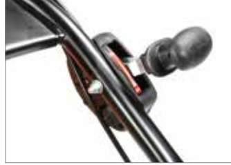
Système de réglage des vitesses variable ( DEB 5158 ).
