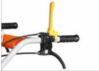
Levier de vitesses sur le guidon.
