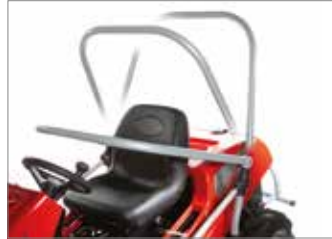
Équipées de série d'une rollbar, de pare-chocs avant et arrière, de protections latérales et de ceintures de sécurité pour une protection complète durant les situations les plus critiques.
