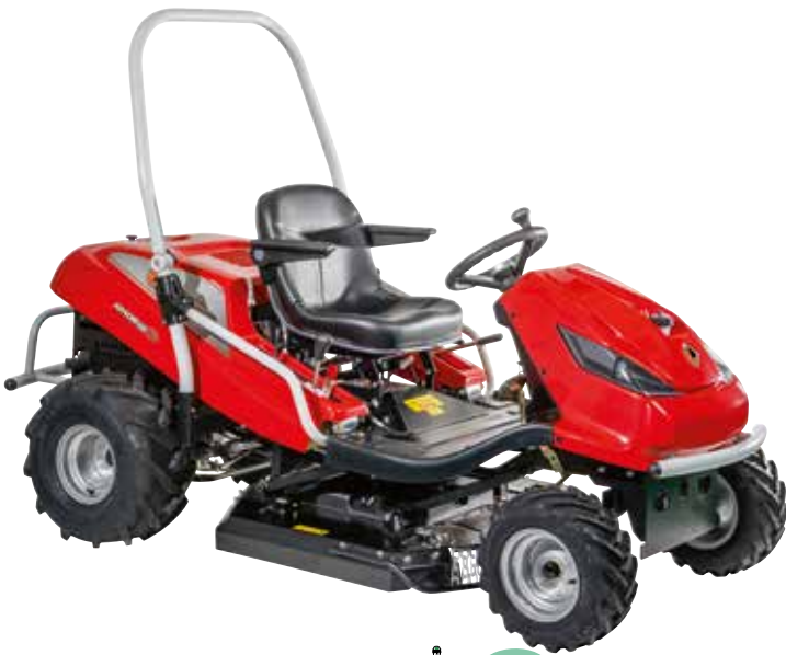
La bande de roulement de grandes dimensions et le centre de gravité abaissé assurent une stabilité optimale même sur terrains accidentés ou à proximité de cours d'eau ou de fossés.
