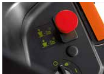
L'embrayage électromagnétique s'engage rapidement et sans bruit grâce à une commande spécifique au tableau de bord.
