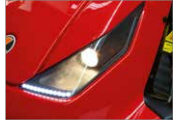
Feux avant avec ampoules halogènes et à led assurant une bonne visibilité sur la zone à tondre et lorsque l'éclairage est mauvais.
