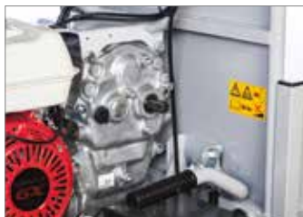
Независимый отбор мощности при 2100 об/мин.
