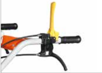
Рычаг на руле для переключения передач.
