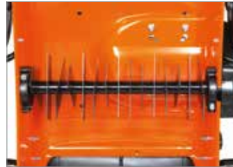
Ротор, состоящий из 15 стационарных ножей.
