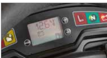
O display LCD permite uma visualização rápida e imediata das principais informações do mini-trator como, por exemplo, horas de funcionamento, tensão da bateria, nível do depósito.
