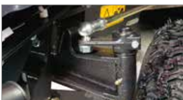
Eixo dianteiro fabricado com uma fusão de aço para resistir também às aplicações mais extremas e a eventuais choques.
