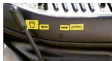
Sistema “Change over”, que, através de uma cómoda alavanca, permite fechar o túnel de carga, passando automaticamente da função de recolha à função mulching.
