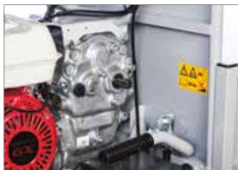
Tomada de força independente de 2.100 rpm.
