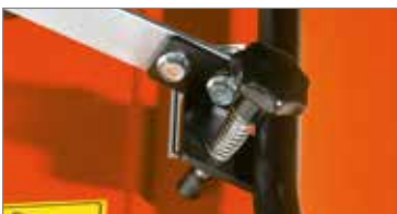
Sistema de regulação da altura com memória, para reposicionar rapidamente a máquina à altura desejada após as deslocações.
