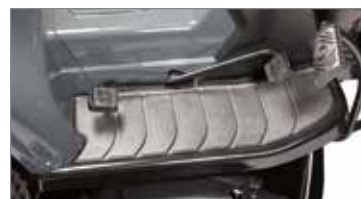
Novos mini-tratores de descarga lateral com velocidade regulada a partir de um duplo pedal que actua directamente na transmissão hidrostática. Graças a esta solução, é possível variar o sentido de marcha e manter o controlo da velocidade durante a utilização.
