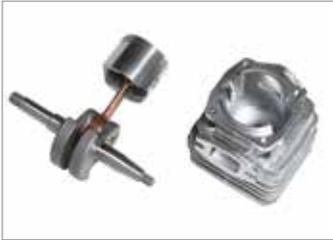
Piston à 2 segments, vilebrequin et bielle en acier forgé et usiné, cages à rouleaux, cylindre revêtu de nickel : tous ces éléments assurent un rendement constant et durable même en cas d'utilisation en conditions sévères.
