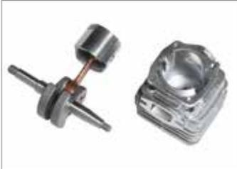
Piston à 2 segments, vilebrequin et bielle en acier forgé et usiné, cages à rouleaux, cylindre revêtu de nickel : tous ces éléments assurent un rendement constant et durable même en cas d'utilisation en conditions sévères (GS 371, GS 411).
