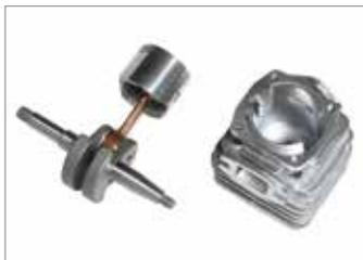
Piston à 2 segments élastiques, vilebrequin et bielle en acier forgé et usiné, cages à rouleaux, cylindre chromé : tous ces éléments assurent un rendement constant et durable même en cas d'utilisation en conditions sévères.
