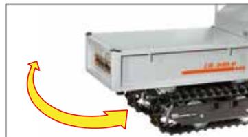
Le rayon de braquage est réduit pour se déplacer aisément dans les chantiers ou au milieu des serres et des vignes.
