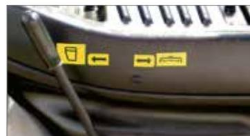
Système «Change over» qui permet, à travers un levier, de fermer le tunnel de remplissage en passant automatiquement du ramassage à la fonction mulching.
