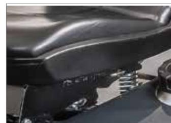
Position de travail confortable grâce au siège réglable directement à partir du poste de conduite en fonction de la taille de l'opérateur. Siège avec accoudoirs pour les modèles (124).
