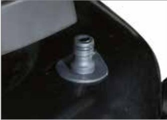
Le raccord rapide «Deck Wash System» monté directement sur le plateau de coupe, permet de diriger l'eau directement à l'intérieur pour faciliter les opérations de nettoyage du système de coupe.
