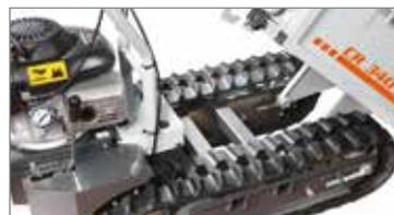
Châssis robuste avec structure en acier. Le centre de gravité assure une excellente stabilité durant le travail, y compris sur les terrains inclinés. La position surélevée du moteur et de la transmission facilite l'entretien.
