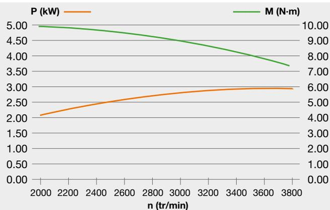
**Remarques :** moteur au volant résistant, utile pour les opérations nécessitant un moment d'inertie élevé
