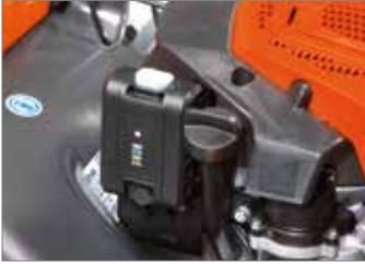
Les modèles **TKE**, avec moteur Emak à démarrage électrique à batterie rechargeable, se mettent en marche en douceur. Le moteur peut également être mis en marche avec la corde de lanceur.
