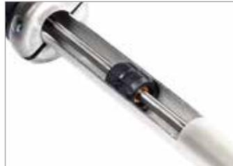
Haute fiabilité grâce à l'arbre de transmission rigide de Ø 8 mm qui glisse sur 6 coussinets auto-lubrifiants.
