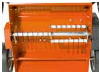
Rotor avec 28 couteaux flottants montés sur roulement sphérique et système de graissage.
