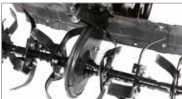
Le carter de protection de la transmission est renforcé pour résister contre les pierres et les chocs accidentels.
