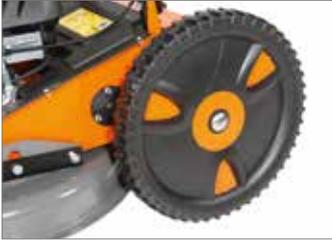
Roues arrière de grandes dimensions avec effet différentiel.
