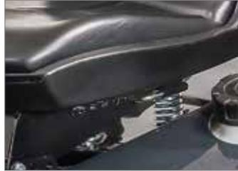
Position de travail confortable grâce au siège réglable directement à partir du poste de conduite en fonction de la taille de l'opérateur.
