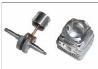
Piston à 2 segments élastiques, vilebrequin et bielle en acier forgé et usiné, cages à rouleaux : tous ces éléments assurent un rendement constant et durable même en cas d'utilisation en conditions sévères.
