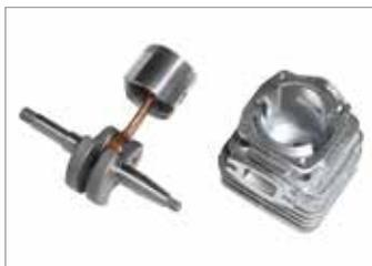
Piston à 2 segments élastiques, vilebrequin et bielle en acier forgé et usiné, cages à rouleaux, cylindre avec pièce au nickel : tous ces éléments assurent un rendement constant et durable même en cas d'utilisation en conditions sévères.
