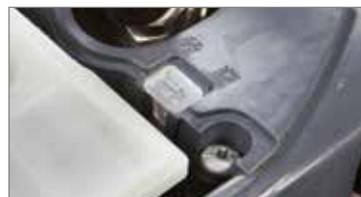
« Ice device » : permet de travailler sans problèmes même avec des températures basses (inférieures à 0 °C) en évitant la formation de glace sur le filtre à air.
