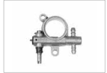
Pompe à huile réglable en aluminium : facilite le travail de l'opérateur car elle permet de varier le débit d'huile en fonction du besoin et du guide. Le débit nul de l'huile lorsque le moteur tourne au ralenti réduit la consommation et limite l'impact environnemental.
