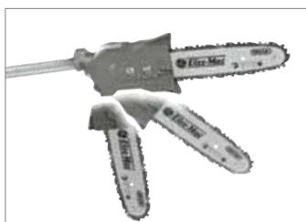
Simple système de fixation de la perche élagueuse : permet de la régler sur 5 positions de coupe (de 0° à 90°) afin de garantir une visibilité excellente sur la zone de travail pour plus de précision.
