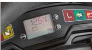
L'afficheur LCD visualise toutes les informations principales de la tondeuse autoportée telles que les heures de service, la tension de la batterie et le niveau de carburant.
