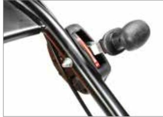
Système de réglage des vitesses variable (**DEB 5158**).
