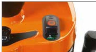
L'embrayage électromagnétique s'engage rapidement et sans bruit grâce à une commande spécifique au tableau de bord.
