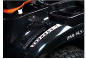
Réglage de la hauteur de coupe par levier à portée de main et doté d'une échelle graduée qui permet de visualiser immédiatement le niveau de la hauteur de coupe souhaitée.
