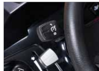
Le modèle 125 dispose du système « Cruise control » qui permet de définir une vitesse constante afin d'optimiser les temps de travail.
