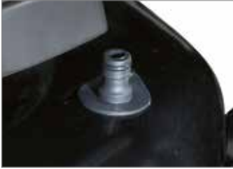
Le « Deck Wash System », branchement rapide du tuyau d'arrosage sur le plateau de coupe, permet un nettoyage facilité (106).
