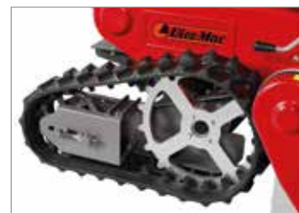
Système de transmission à chenilles, oscillant sur le plan vertical (modèle 100 TR ).
