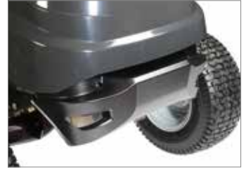
Grand pare-chocs avant en acier assurant une grande robustesse et une protection en cas de chocs.
