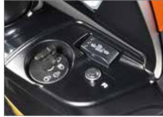
L'opérateur actionne les lames en appuyant simplement sur le bouton de commande de l'embrayage électromagnétique présent sur le tableau de bord. Ce système permet d'enclencher les lames sans contre-coups.
