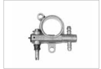
Bomba de aceite realizada en aluminio y regulable: permite variar el caudal de aceite en función del uso de la máquina y de la combinación de espada y cadena. El caudal nulo de aceite con el motor al mínimo asegura menor consumo y mayor protección del ambiente.
