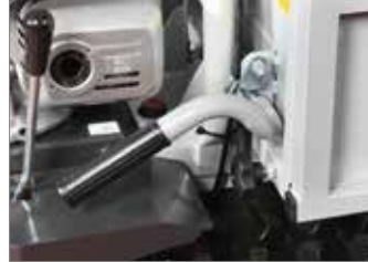
Basculamiento manual con sistema de bloqueo automático.
