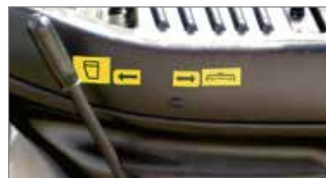
Sistema "Change over" que permite cerrar el túnel de carga con una cómoda palanca, pasando automáticamente de la función de recogida a la función mulching.
