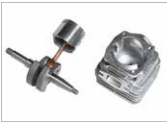
Pistón con dos segmentos elásticos, cilindro inyectado con revestimiento de níquel, biela y cigüeñal forjados: mayor resistencia y duración del motor.
