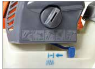
La representación gráfica de las fases de arranque hace más fácil la puesta en marcha (modelo BC 241 ).
