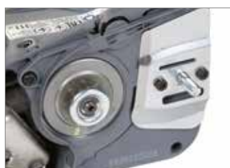
Embrague OnBoard: montaje rápido de la herramienta de corte, embrague más limpio y prestaciones duraderas.
