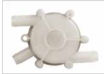
La bomba de empuje o booster mantiene mezclada la solución de líquidos en el depósito y, al mismo tiempo, aumenta y estabiliza el caudal de salida del producto.
