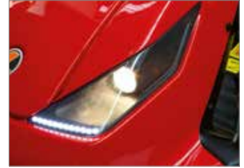
Los faros delanteros con luces halógenas y de ledes proporcionan una excelente visión del área de corte incluso en las horas de menos luz.
