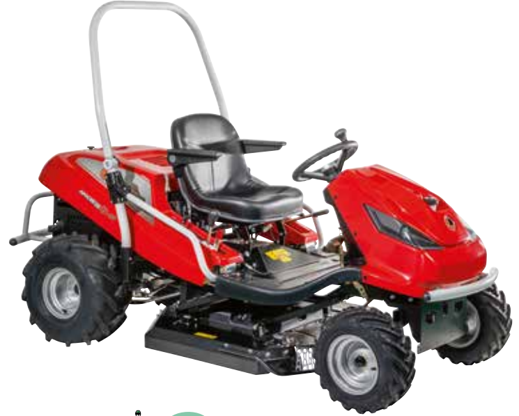
Equipados de serie con arco, parachoques delantero y trasero, protecciones laterales y cinturones de seguridad para minimizar los riesgos incluso en situaciones difíciles.
