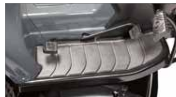
Nuevos tractores con descarga lateral y regulación de la velocidad mediante un doble pedal que actúa directamente sobre la transmisión hidrostática. Esta solución permite variar el sentido de marcha y mantener el control de la velocidad durante el uso.
