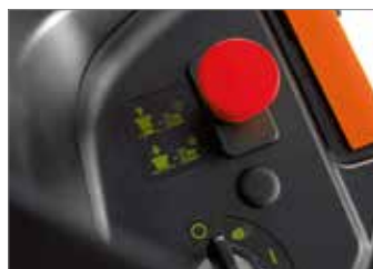
El acoplamiento del embrague electromagnético se realiza de modo rápido y silencioso mediante un cómodo botón situado en el tablero de mandos.
