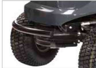
Amplio parachoques frontal que protege de golpes accidentales.
