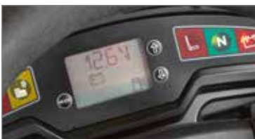
La pantalla LCD permite controlar rápidamente los datos principales del tractor, como las horas de uso, la tensión de la batería y el nivel del depósito.
